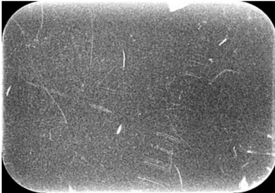
Slika 29. Primjer: izgrebana CR folija=> ne smije se koristiti
